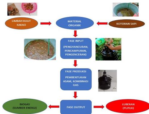
Gambar 1. Proses pembuatan biogas
